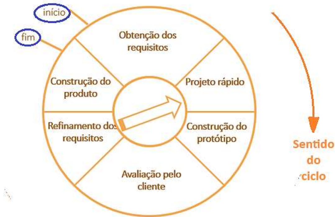
Figura 2. Modelo de construção de protótipo.
