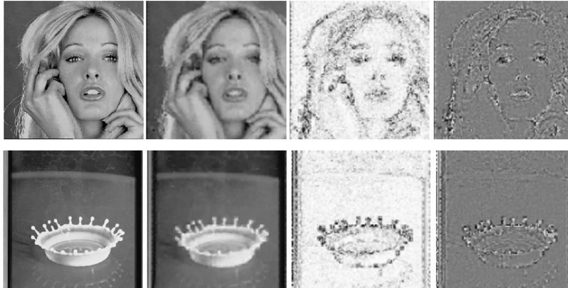
Figura 8.20 - Resultados obtidos da compressão Fractal usando a técnica de Sub Busca Local com  $\Delta = 8$  e blocos molde de  $4 \times 4$  *pixels*.
