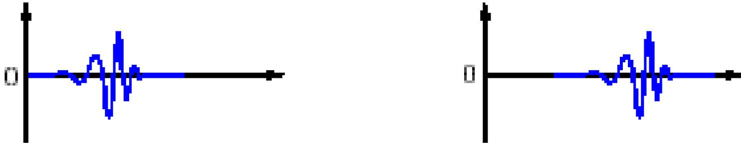
Figura 8.23. - Fator de deslocamento, à direita função  $\Psi(t)$  *wavelet*, à esquerda função  $\Psi(t-b)$  *wavelet* deslocada
