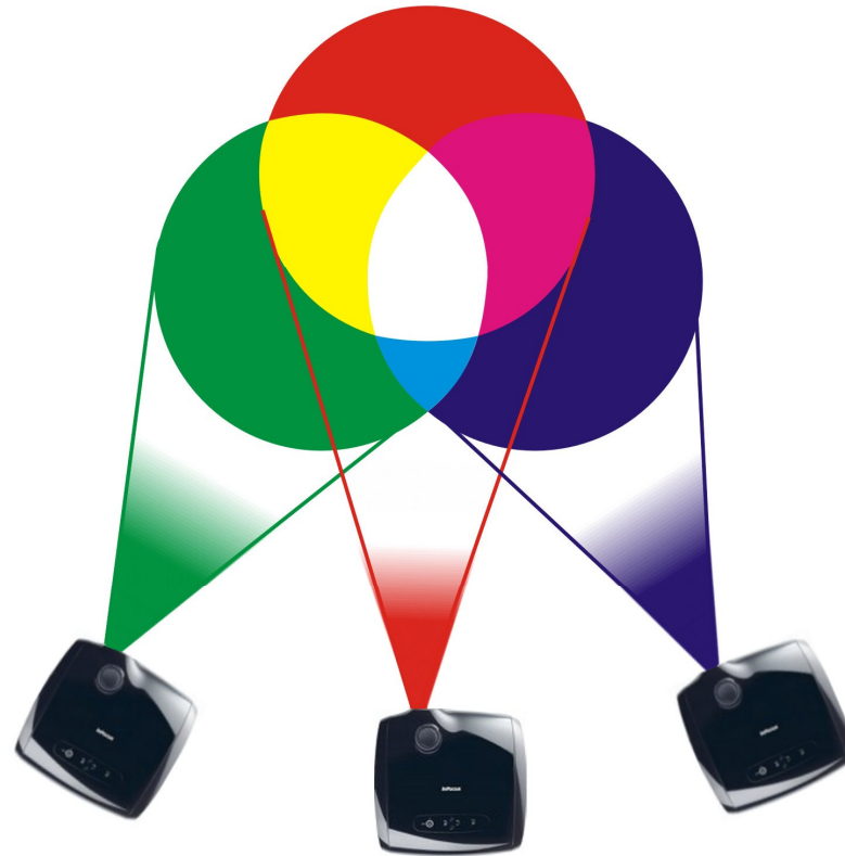
Figura 2.16 – Cores aditiva obtidas pela combinação de luzes RGB
